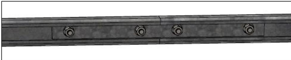
Para fixá-los na estrutura os trilhos devem ser posicionados apoiados sobre o perfil longitudinal com as abas voltadas para a frente. Para garantir maior rigidez do conjunto, as junções que unem os perfis devem estar localizadas acima do perfil longitudinal, pode haver um deslocamento da união em até 200 mm para a esquerda ou direita a fim de corrigir erros de posicionamento.
