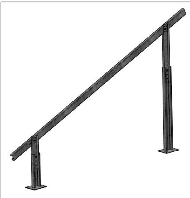
Estrutura fixada no solo através de parafusos presos a fundação de concreto armado.
